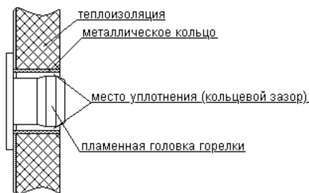
Рис. 5. Фрагмент фронтальной крышки котла (уплотнение зазора между крышкой и пламенной головкой).
