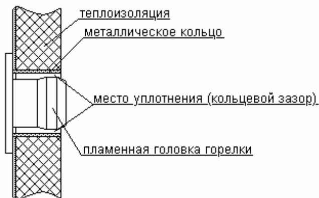
Рис. 12. Фрагмент фронтальной крышки котла (уплотнение зазора между крышкой и пламенной головкой).
